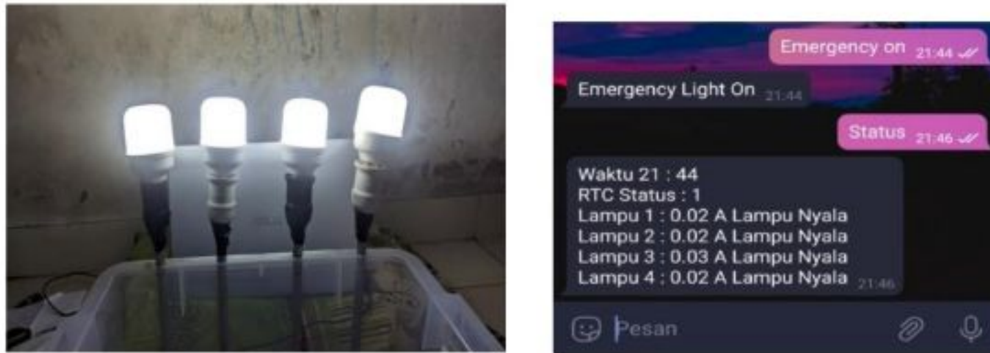
Gambar 4.9 Pengujian keseluruhan dengan empat titik lampu normal.
