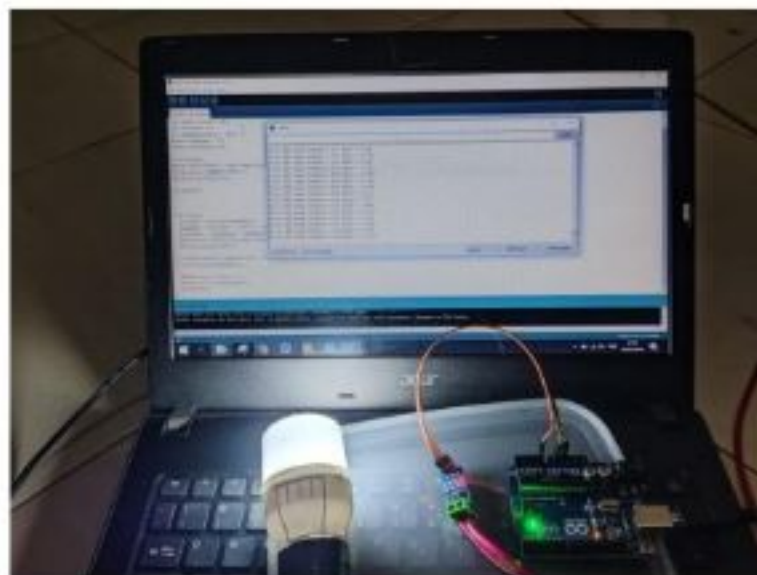
Gambar 4.5 Pengukuran arus lampu menggunakan sensor ACS712.
