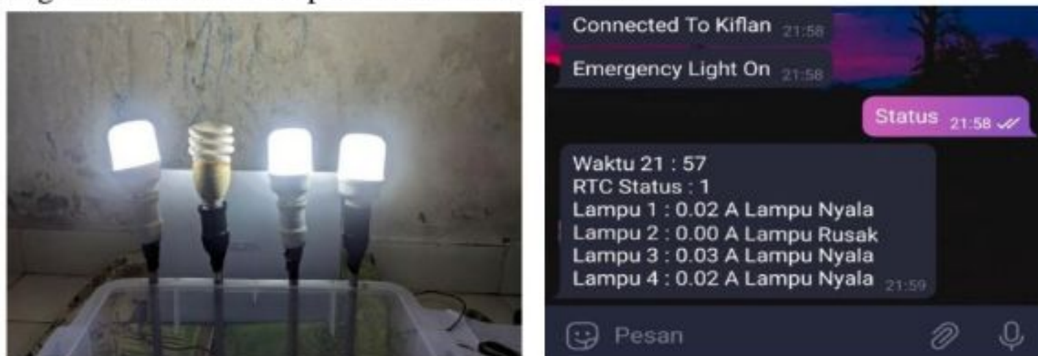
Gambar 4.10 Pengujian keseluruhan dengan salah satu titik lampu rusak.
