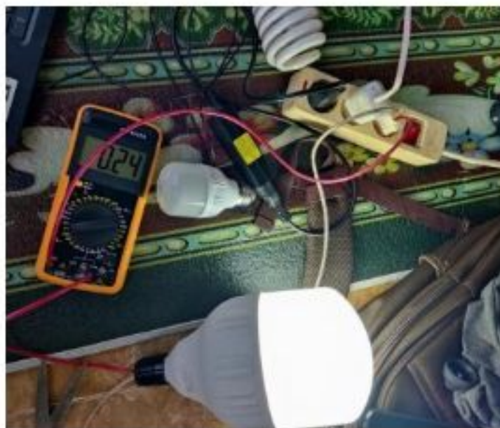
Gambar 4.6 Pengukuran arus lampu menggunakan Multimeter Digital DT9205A.
