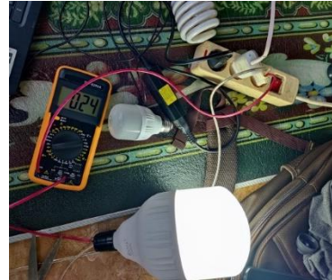
Gambar 12. Pengukuran arus lampu menggunakan Multimeter Digital DT9205A.
