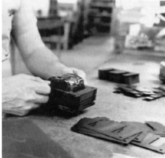
Gambar 1.8. Memasukkan lempeng laminasi ke dalam kumparan transformator
