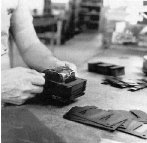
Gambar 1.8. Memasukkan lempeng laminasi ke dalam kumparan transformator
