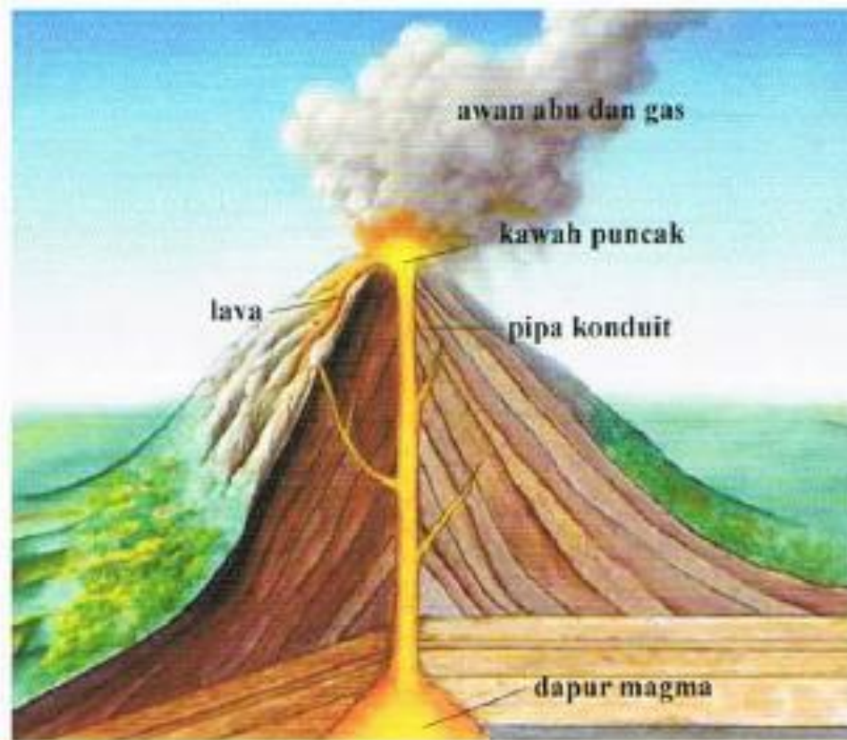
Gambar 2.6. Sketsa gunung api komposit, yang memperlihatkan dapur magma, retas, korok atau pipa kepundan, kawah puncak, aliran lava dan awan abu, dan gas gunung api (Bronto, 2006)
