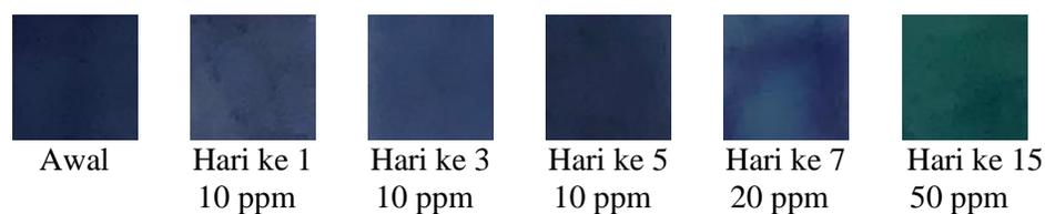
Gambar 4. Perubahan warna aplikasi sensor pada suhu *chiller* ( $\pm 10^\circ\text{C}$ )
