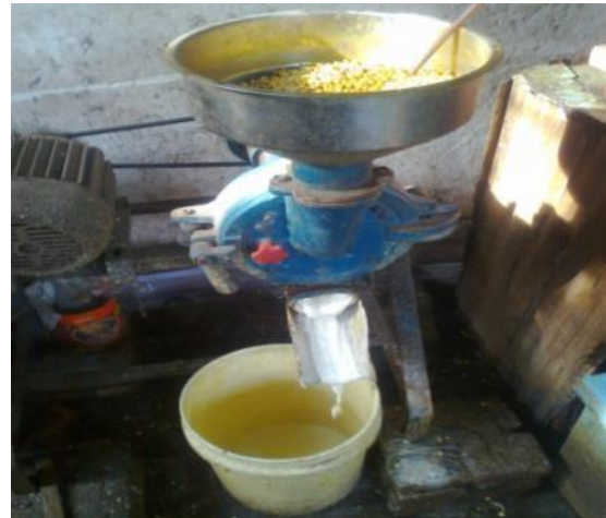
(2). Penggilingan Kedelai dengan mesin
