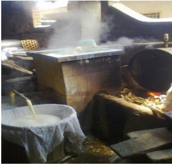
(3).a. Perebusan bubur kedelai dengan boiler (uap panas)
