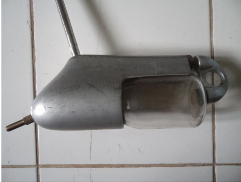
Gambar 3. Alat Ukur Sedimen Terapung Tipe USDH 48
