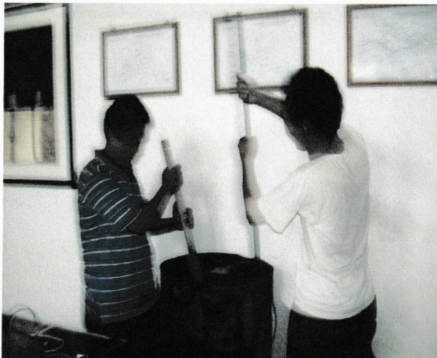
Foto 7. Proses pengambilan Data. Satu orang mengaduk agar sedimen terlarut dan satu orang lagi memegang tangkai LDR.
