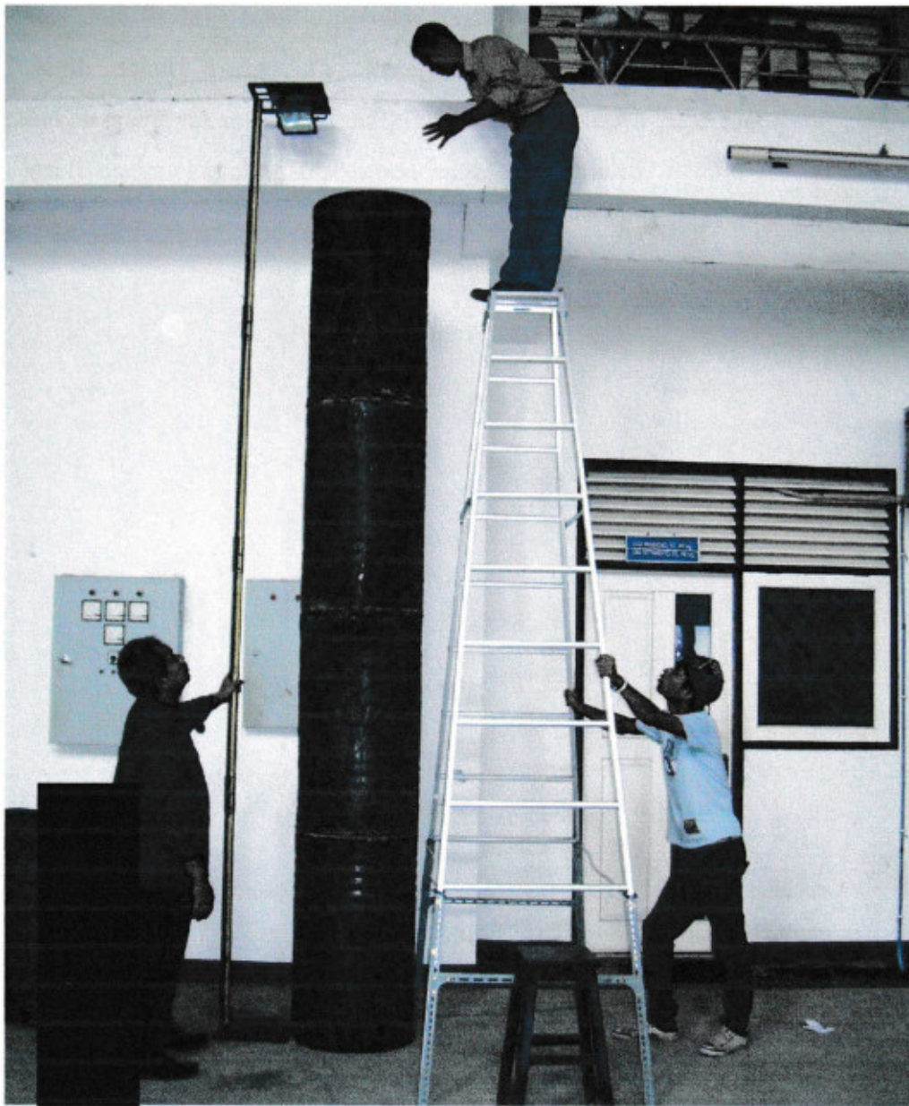
Gambar 4.10. Alat Ukur Sedimen Suspensi dan Bak Ukur Setinggi 3,5 m
