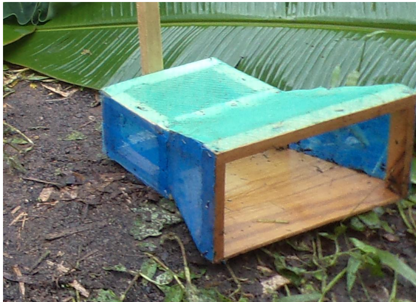
Gambar 5. Alat penangkap sedimen dasar ( bedload sampler )
