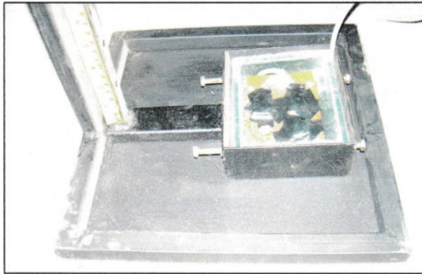
Gambar 3.2. Rangkaian LDR yang Diletakkan di Dasar Alat Ukur
