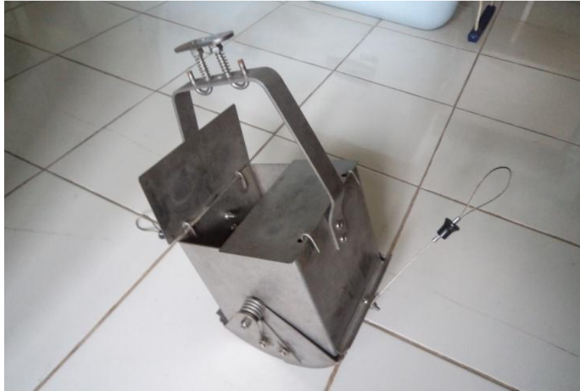
Gambar 6. Alat pengambil sedimen terendap ( serber atau Eikman grab )
