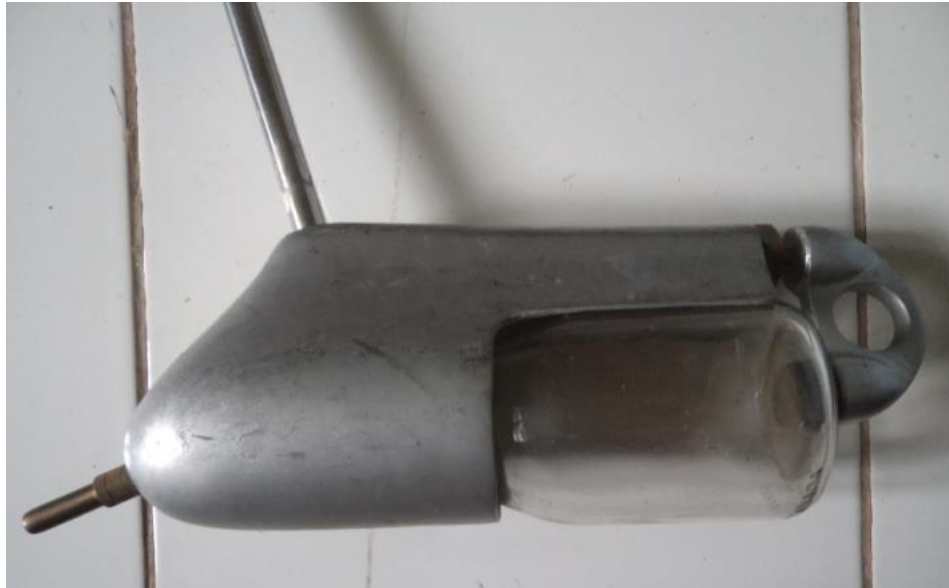
Gambar 3. Alat Ukur Sedimen Terapung Tipe USDH 48 (Saadi et al 2012)
