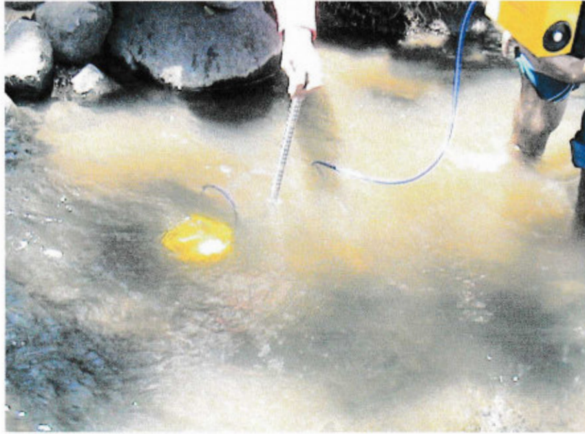
Foto 8. Pengukuran kecepatan aliran di sungai menggunakan peralatan Current Meter. Pengukuran dilakukan pada saat debit sungai kecil (musim kemarau), sehingga sulit untuk dilakukan karena kedalaman air kecil. Pengukuran diatas dilakukan pada palung sungai, sehingga kedalamannya cukup untuk melakukan pengukuran kecepatan menggunakan Current Meter.
