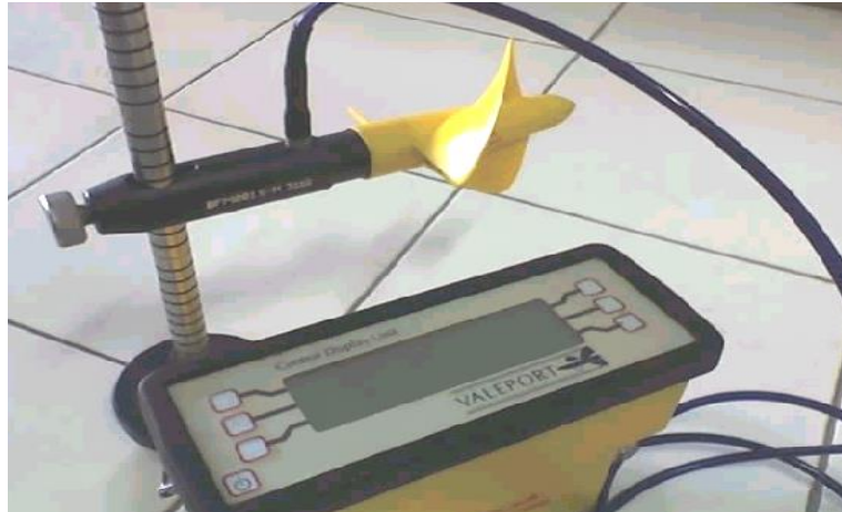
Gambar 2. Alat ukur kecepatan aliran Valeport Model 001
