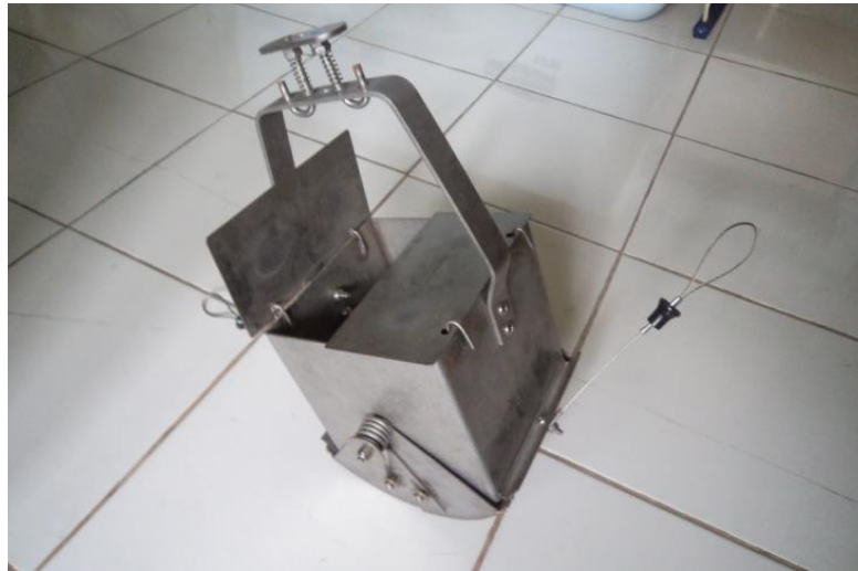
Gambar 5. Alat ukur serber tipe Ekman Grab
