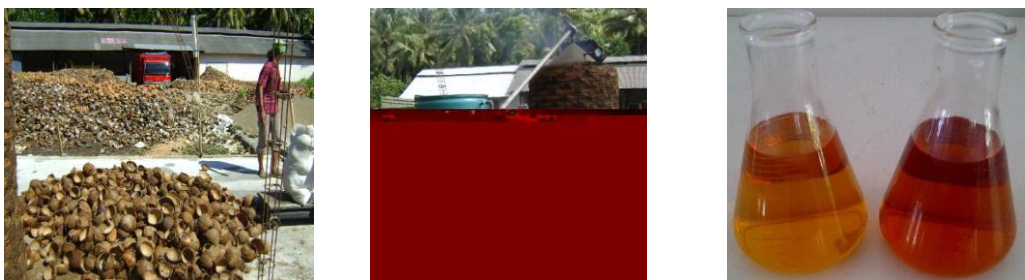
Gambar 6.3. a. Bahan baku, b. Proses pembakaran (pyrolisis) pada pembuatan asap cair Grade 3, c. Asap cair Grade 1 (kiri) dan Grade 2 (kanan) (Widyastuti, 2012).
