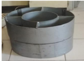
Gambar 3. Alat pengukuran laju infiltrasi cincin ganda
