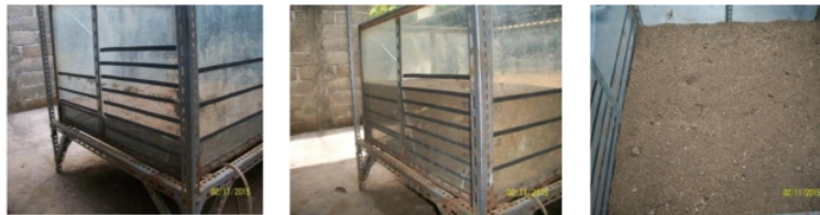
Gambar 3. Penyiapan satu lapisan dan lapisan material 30 cm
