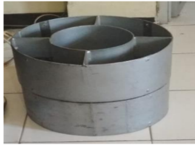
Gambar 2. Alat pengukuran laju infiltrasi cincin ganda
