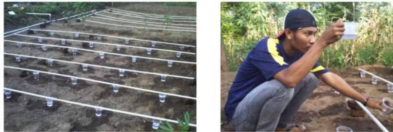
Gambar 1. Pengukuran Keseragaman Irigasi Tetes di Pringgabaya Utara
