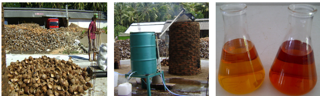
Gambar 1. a. Bahan baku, b. Proses pembakaran dan kondensasi Grade 3, c. Asap cair Grade 1 (kiri) dan Grade 2 (kanan).
