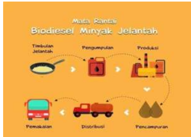
Gambar 3. Mata Rantai Biodiesel Minyak Jelantah
