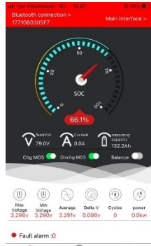
Gambar 7. Kondisi mobil listrik ditinjau dari Smart BMS
