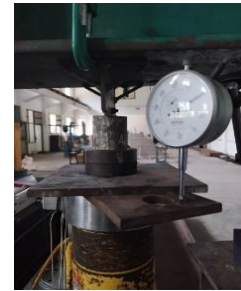
(c) Set-up pengujian metode setengah lubang ganda
