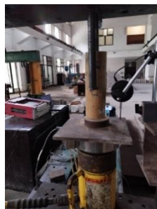
(b) Set-up pengujian metode lubang penuh
