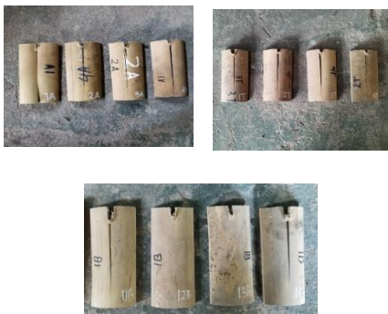
Gambar 14. Kegagalan pada metode setengah lubang bagian ujung, tengah dan pangkal
