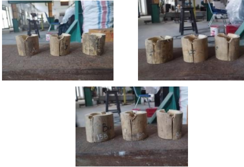
Gambar 16 Kegagalan pada metode lubang penuh bagian ujung, tengah dan pangkal
