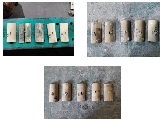
Gambar 15. Kegagalan pada metode lubang penuh bagian ujung, tengah dan pangka
