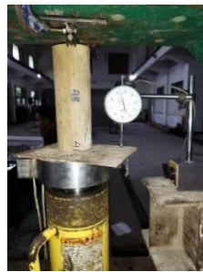
(a) Set-up pengujian metode setengah lubang
