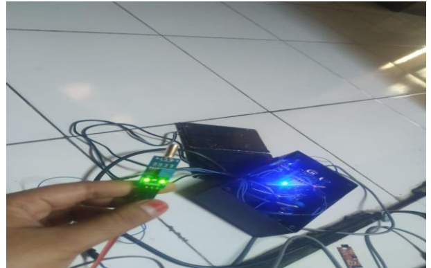
Gambar 4. 3 KY036 metal touch sensor dalam keadaan aktif
