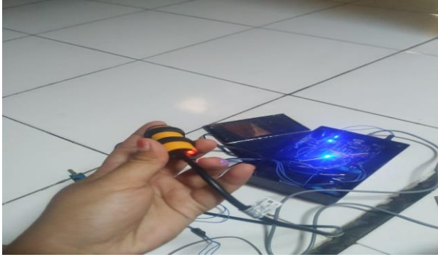
Gambar 4. 6 sensor infrared switch E18-D80NK dalam keadaan mendeteksi
