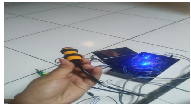
Gambar 4.5 sensor infrared switch E18-D80NK dalam keadaan aktif
