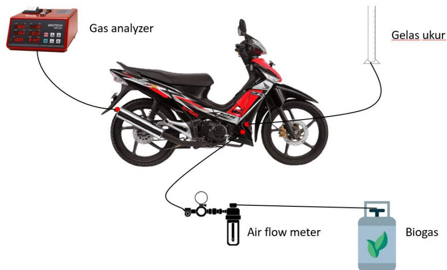
Gambar 1. Rangkaian proses uji emisi bahan bakar ganda
