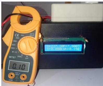
Gambar 11. Pengujian arus pada sensor PZEM-004T
