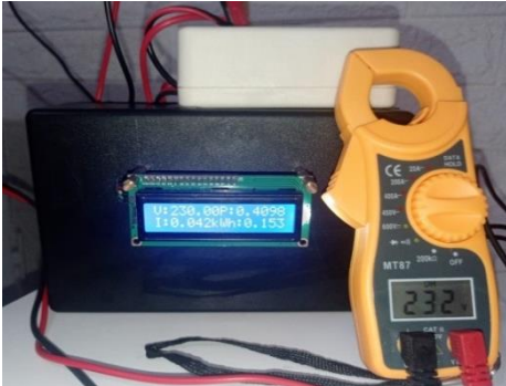
Gambar 10. Pengujian tegangan pada sensor PZEM-004T
