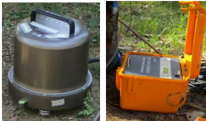
Gambar 2. Seismometer Taide tipe TDV-23S dan Digitizer Taide tipe TDL-303S
