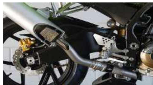
Gambar 3.4 Penggunaan Catalytic Converter pada Knalpot
