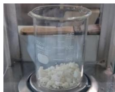
Gambar 4. Selulosa asetat (CA) berbasis BC limbah cair tahu
