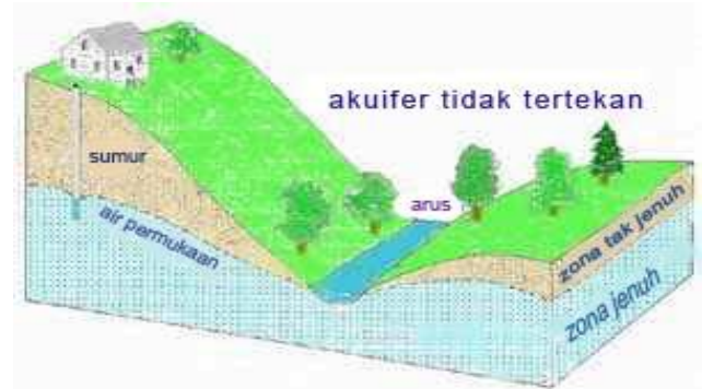
Gambar 2.2 Akuifer bebas atau akuifer tidak tertekan ( Unconfined Aquifer ) (Wuryantoro, 2007)
