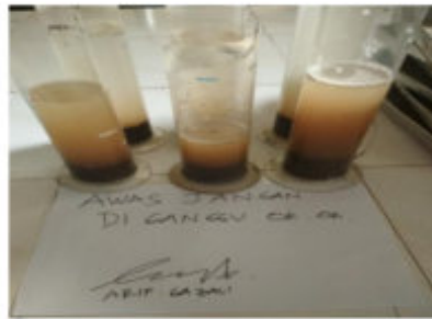
Gambar 10. Proses Pengujian Berat Jenis dengan Gelas Ukur
