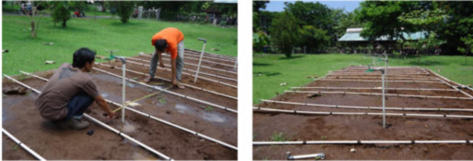
Gambar 3. Persiapan dan Pengujian Sprinkle Mini
