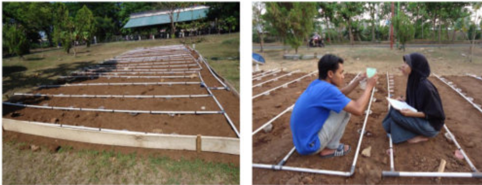
Gambar 2. Persiapan dan Pengujian Keseragaman Sistem Irigasi Tetes
