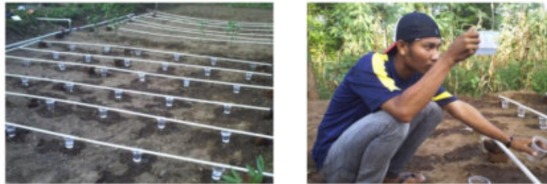
Gambar 1. Pengukuran Keseragaman Irigasi Tetes di Pringgabaya Utara
