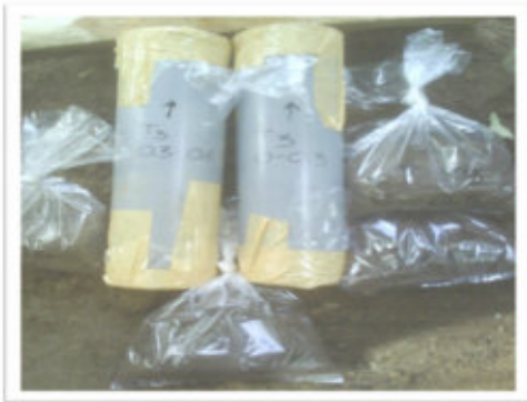
Gambar 2. Sampel tanah asli (undisturb) dan sampel tanah terganggu (disturb)
