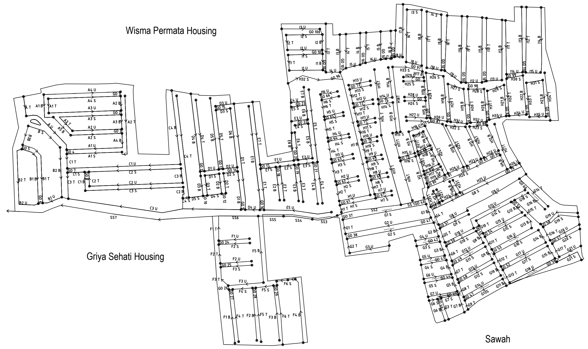
Gambar 4.3 Skema Jaringan Drainase Perumahan Skala 1 : 2000
