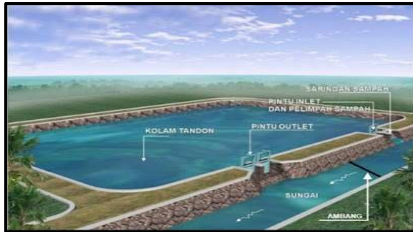
Gambar 2.2 Sketsa Layout Kolam Retensi Sumber : Direktorat Jendral Cipta Karya, 2010
