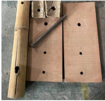
Gambar 13. Tipe Kegagalan Sambungan dengan Baut Diameter 19 mm dan 21 mm
