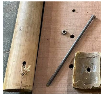
Gambar 12. Tipe Kegagalan Sambungan dengan Baut Diameter 10 mm, 12 mm dan 16 mm
