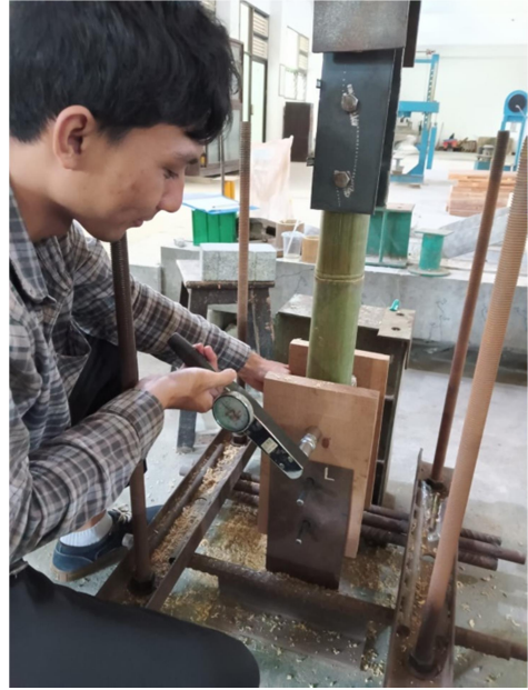
Gambar 3.8 Pemasangan Benda Uji Pada Loading Frame
