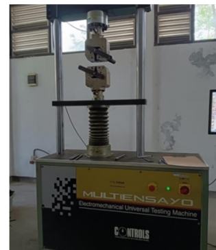
Gambar 3.2 Pengujian kuat tarik baut dengan alat Universal Testing Machine
