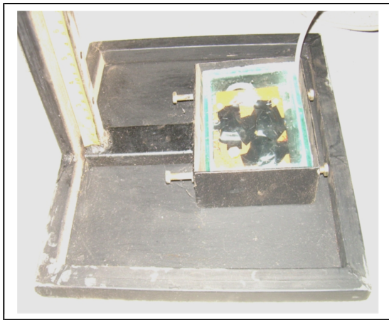
Gambar 2. Rangkaian LDR yang diletakkan di dasar alat ukur
