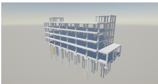
Gambar 3 Hasil Rendering Modeling Struktur Gedung Perawatan RSUD Provinsi NTB dengan Trimble Connect Visualizer
