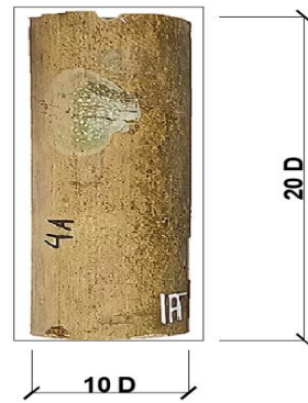
Gambar 3. Benda uji kuat tumpu metode setengah lubang
