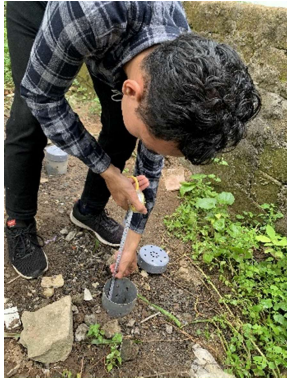
Pengukuran laju infiltrasi hari ke-9
