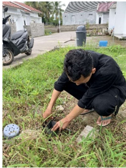
Pengukuran laju infiltrasi hari ke-21
