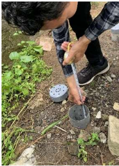
Pengukuran laju infiltrasi hari ke-17
