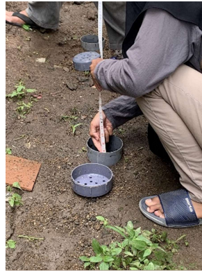
Pengukuran laju infiltrasi hari ke-10
