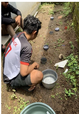
Pengukuran laju infiltrasi hari ke-7
