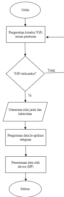
Gambar 4. Bagan Alir Program Nodemcu ESP8266
