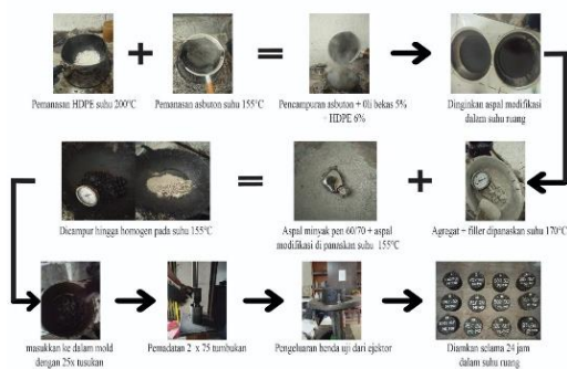
Gambar 12. Proses Pembuatan Benda Uji Untuk Aspal Modifikasi
