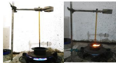
Gambar 10. Uji titik nyala.
