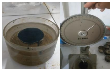
Gambar 5. Uji penetrasi aspal.
