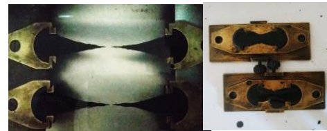
Gambar 6. Uji daktilitas aspal.
