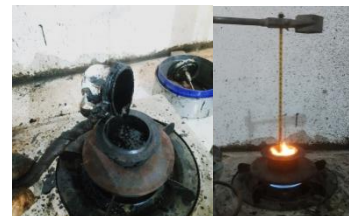
Gambar 11. Uji titik bakar.
