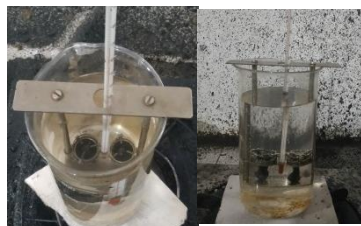
Gambar 9. Uji titik lembek aspal.
