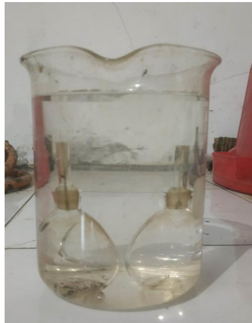
Kalibrasi piknometer (perendaman piknometer beserta penutupnya)
