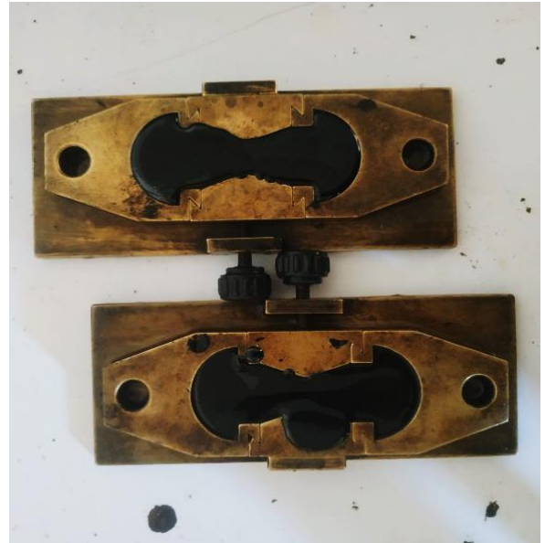
Benda uji didinginkan pada suhu ruang
