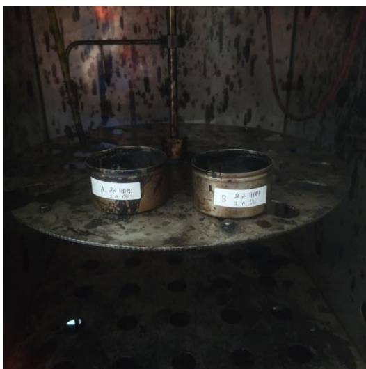
Benda uji dimasukkan ke dalam oven dan piringan di putar
