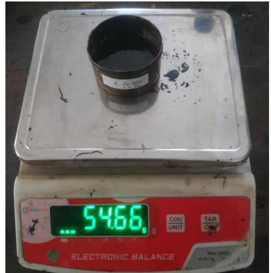
Penimbangan benda uji setelah dingin
