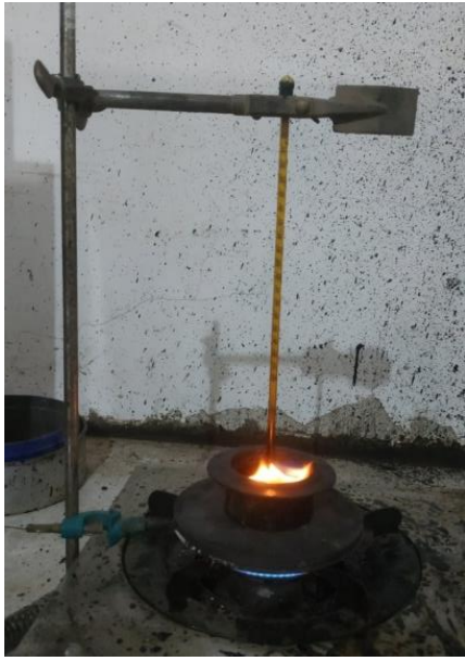
Titik nyala aspal ketika api menyala kurang dari 5 detik
