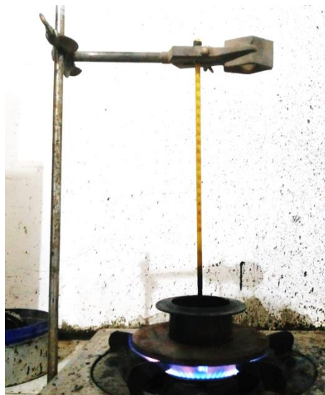
Awal pengujian titik nyala dan titik bakar
