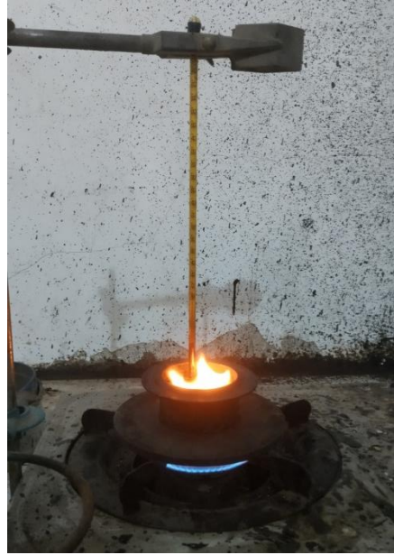
Titik bakar aspal ketika api menyala lebih dari 5 detik
