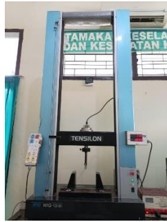
Gambar 3.1 Pengujian kuat tarik baut dengan alat Universal Testing Machine
