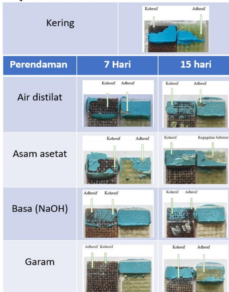
Gambar 4. Mode kegagalan sambungan komposit serat rami dan fiberglass tanpa perlakuan, 7 hari dan 15 hari perendaman.
