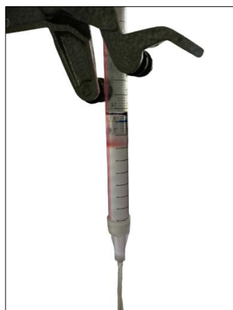
Gambar 5. Proses isolasi protein sampel menggunakan kolom Sephadex G-75.
