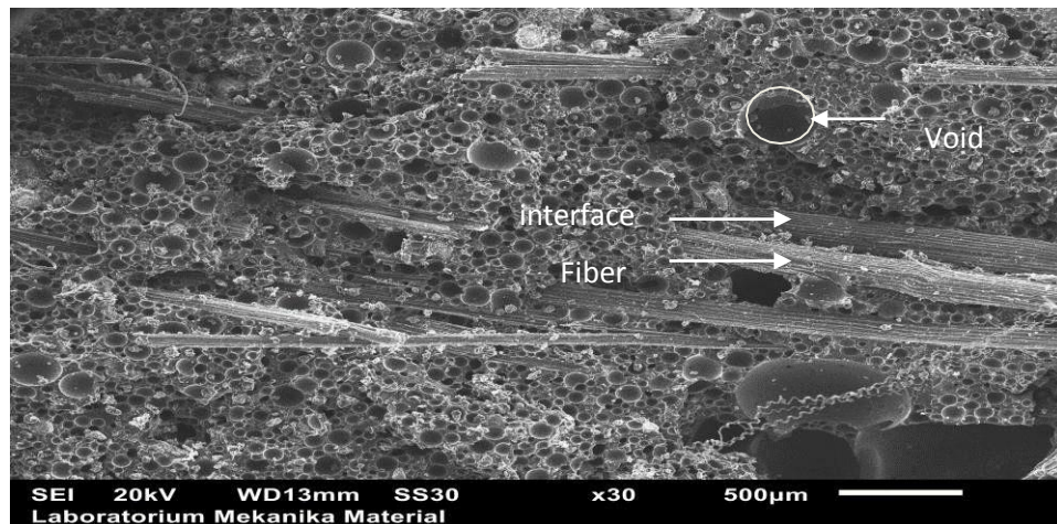
Gambar 4.8 SEM Komposit Serat Sembukan S10 % dan filler 20%
