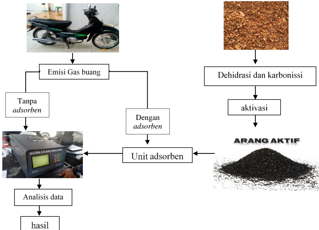
Gambar 2. Skema pengujian emisi
