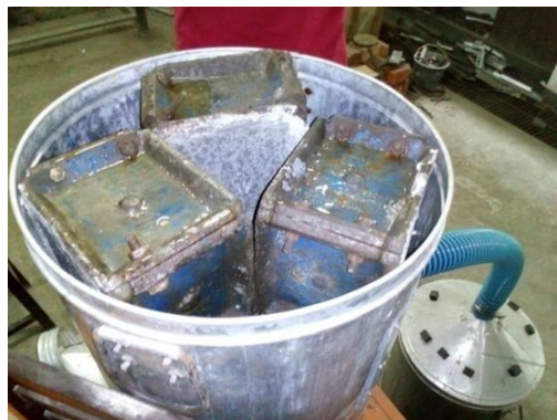
Gambar 3. Tampak atas posisi perletakan benda uji didalam ruang penguapan
