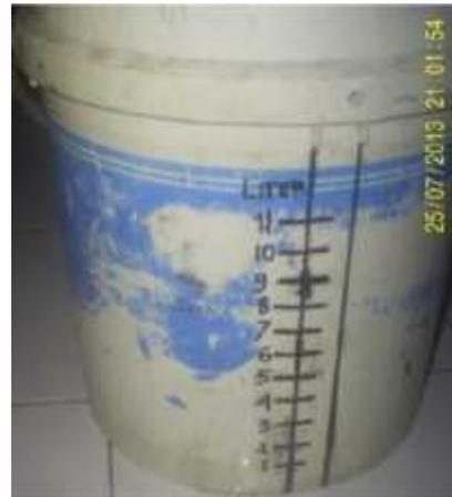
**Gambar 3.3** Gelas ukur yang digunakan untuk pengukuran debit air
