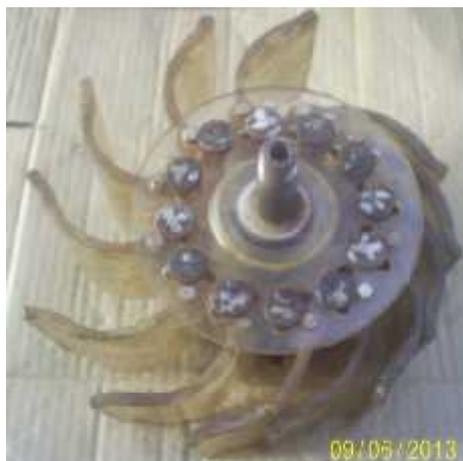
**Gambar 3.7** Sudu yang digunakan saat pengujian
