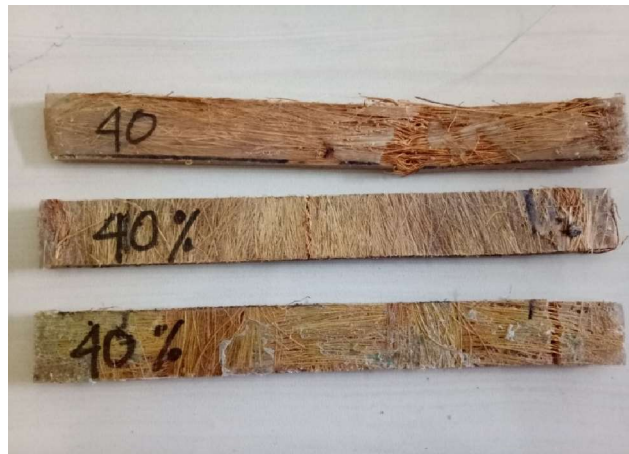
Gambar 3 Komposit hasil pengujian kuat tarik untuk variasi orientasi serat
