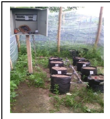
Gambar 14. Jaringan Sistem Pemantauan pada Sistem Irigasi Tetes Bawah Permukaan Tanah
